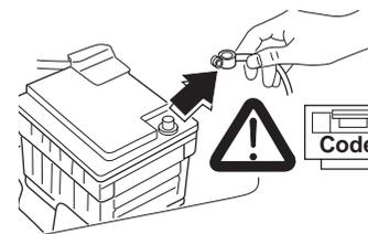
**Prima di iniziare l'installazione scollegare il cavo negativo dalla batteria e ricollegarlo solo ad installazione ultimata.**
