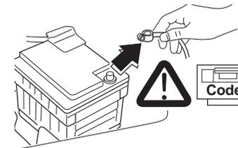
**Avant de commencer l'installation déconnecter le pôle négatif de la batterie et le rebrancher à la fin de l'installation.**
