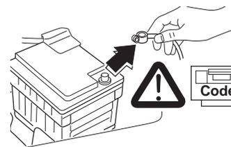
**Antes de iniciar la instalación desconectar el cable negativo de la batería y volver a conectarlo solamente una vez finalizada la instalación.**
