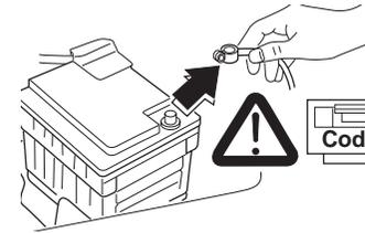
Bevor man mit dem Einbau beginnt, das Minuskabel von der Batterie abklemmen, um es erst nach Abschluß der Installation wieder anzuschließen.
