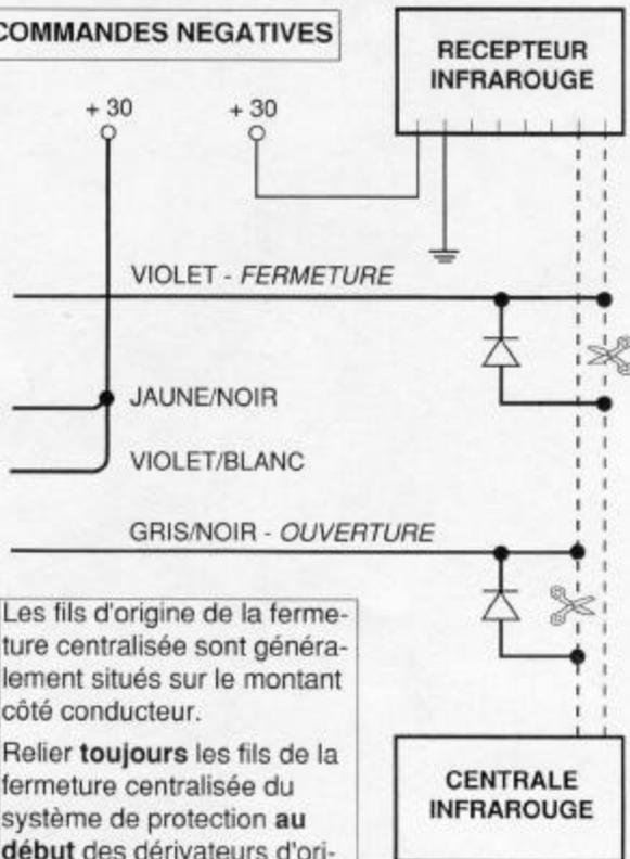
Les fils d'origine de la fermeture centralisée sont généralement situés sur le montant côté conducteur.
